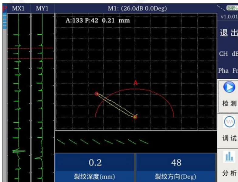
Figura 1 Defecto a 48 grados
